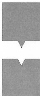
Fig. 7.2 – Ilustração dos perfis macho e fêmea do sistema de vedação
